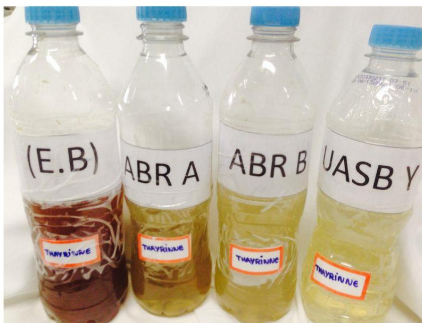
**Figura 1 – Amostras do afluente e efluentes do reator ABR1, ABR2 e reator UASB**
